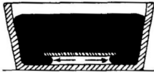
Figura 58. El mercurio no penetra por debajo de la lámina aplicada al fondo
