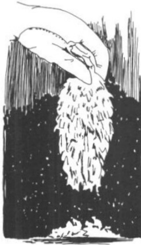
Figura 89. El anhídrido carbónico congelado forma una masa parecida a la nieve; después de prensarla se obtiene «hielo seco»
